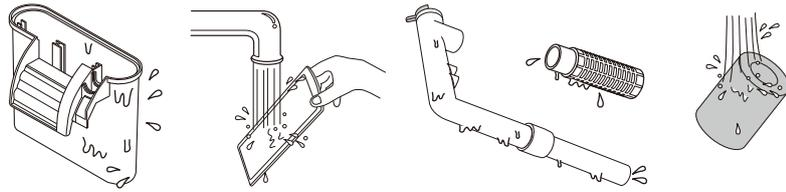
1.フタ、本体、パイプ類を軽く水洗いし、専用ろ過材、ストレーナー、ストレーナースポンジも軽くすすぐ。
