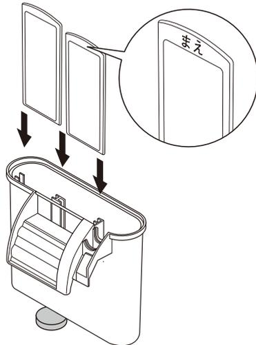
1.専用ろ過材の「まえ」の文字を水槽側に向くようにセットし、底部までキチンと差し込む。
