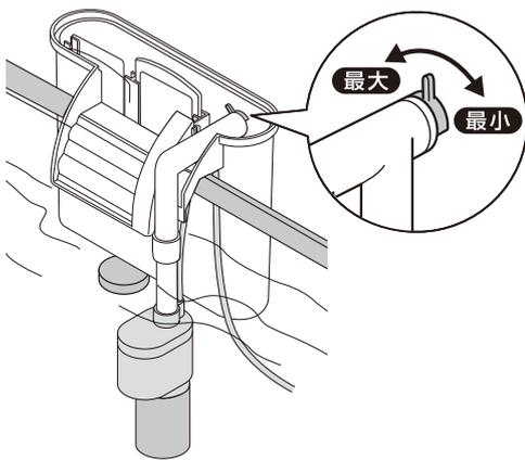
1.流量調節ツマミを最大にする。流量調節ツマミは矢印の方向に回すことによって流量を調節できます。
