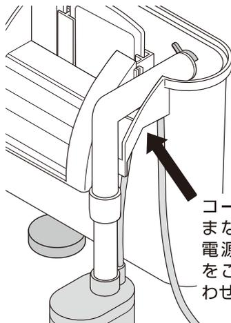
2.電源コードをセットした下方に添わせてセットする。
