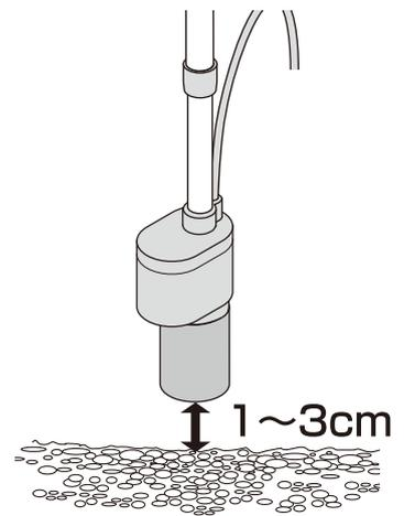
3.モーター故障防止のため、吸引パイプを伸縮させて底面に触れないようにする。
