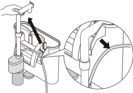
1.電源を切った後、フタを取り、電源コードを外した後に、メインパイプをもち、モーターを取り出す。
