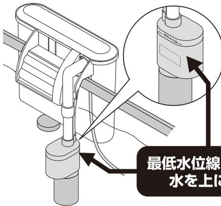
2.水面が必ずモーターの最低水位線より上になるように水位を調節する。
