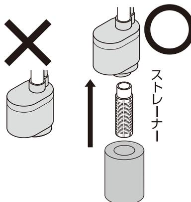
● ストレーナー、ストレーナースポンジは必ず付けて使用する。付けずに使用すると砂やゴミなどを吸い込み、故障の原因になる。
