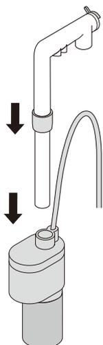
1.パイプ類がセットされたパイプセットを、モーター部に奥まで差し込む。
