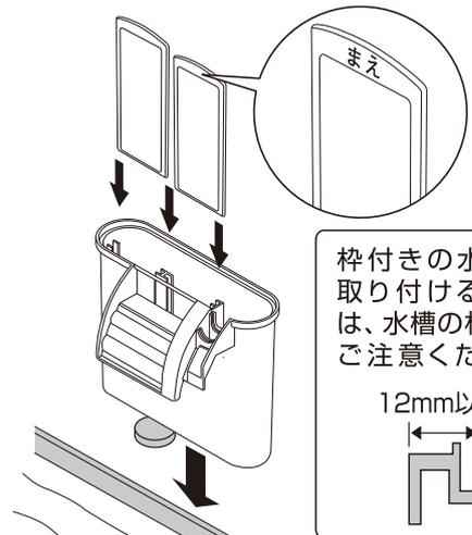
枠付きの水槽に取り付ける場合は、水槽の枠幅にご注意ください。
