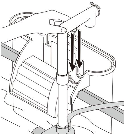
1.メインパイプの突起部を本体の溝(2ヶ所)に合わせてセットする。
