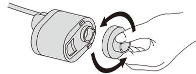
2.モーター部からパイプ類、ストレーナーを外し、モーターカバーを反時計回りに回して取り外す。
